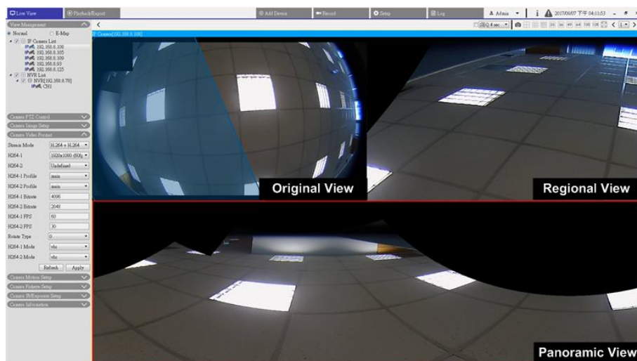
Fig. 13: Vue OPR de configuration du dégauchissement de la caméra Fisheye
